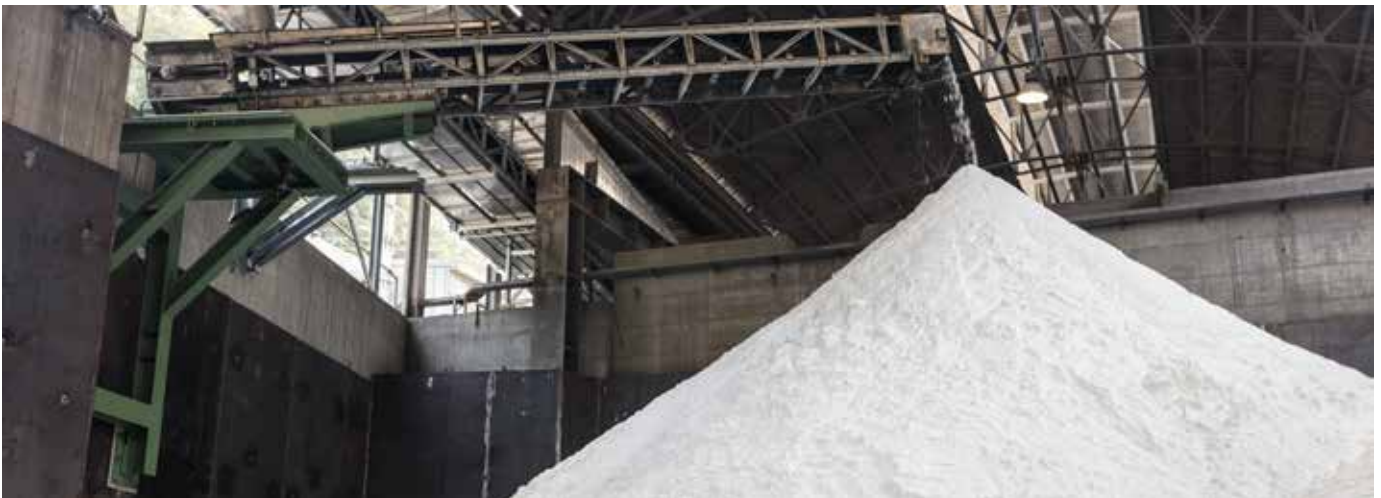
Rückgewonnenes und im Rahmen des Schmelzprozesses wiederverwendetes Salz
